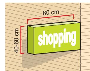
Banderines (D) Vuelo: 80 cm. Altura: 40 cm en zonas protegidas y 60 cm en el resto. Altura mínima: 225 cm.
